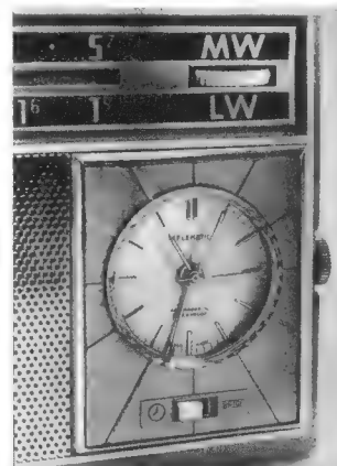
Bild 3. Das stoßgesicherte Schweizer Uhrwerk trägt unten den Umschalter für Wecken und Normalbetrieb
